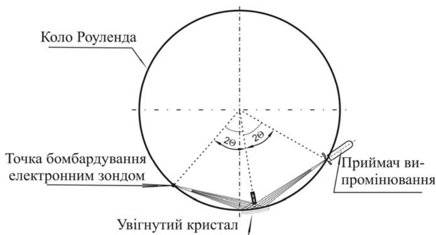
Рис. 2.4. Принципова схема спектрометра хвильової дисперсії
